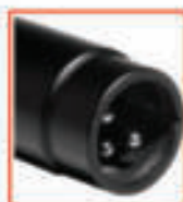
Microfone de Medida e Referência Modelo: CSR MR2000 (Cód.: 10333) Condenser com Pre-Amplificador FET Padrão Polar: Omnidirecional Resposta: 20Hz~20KHz Sensibilidade: -37dB Impedância: 200 \Omega Alimentação: Phantom Power 9~52Vdc Dimensões: 192/21/13mm
